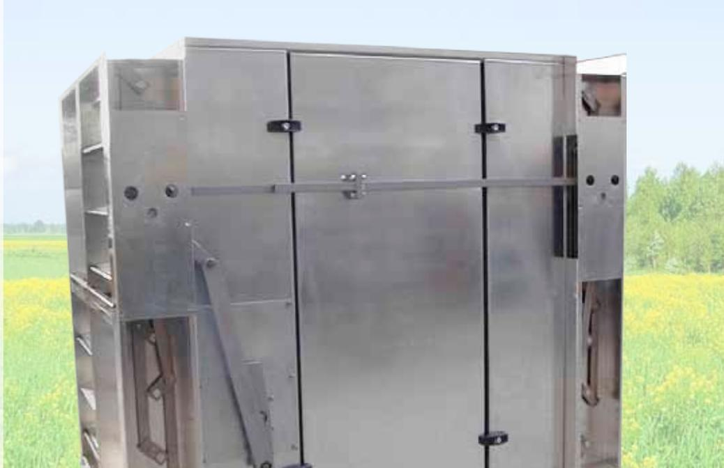
Модуль теплового аккумулятора с системой клапанов
