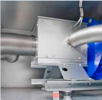
Закрытый мотор с принудительной вентиляцией
